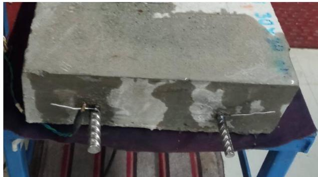
**Figura 7. Losa de concreto reforzado recién fabricada.**
