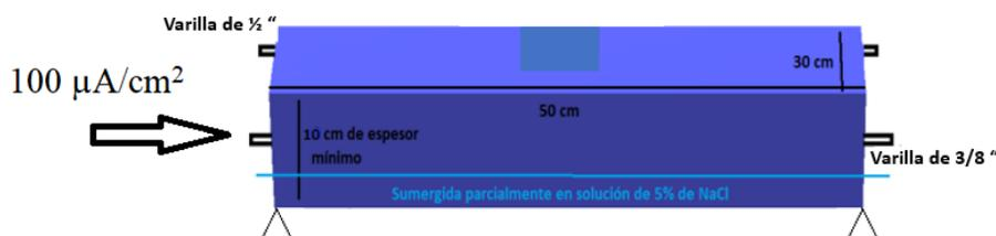
Figura 4. Losa de concreto reforzado fabricada.
