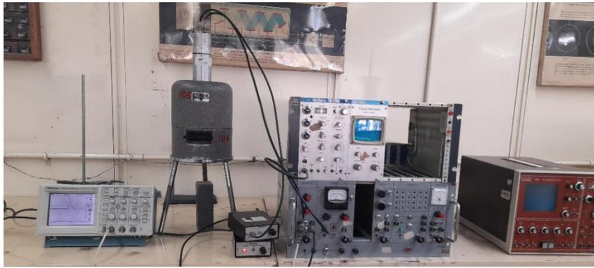
**Figura 3. Sistema de análisis multicanal**
