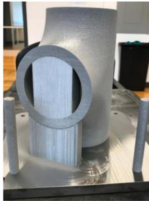
**Figura 8. Tee construida con PBF [12].**
