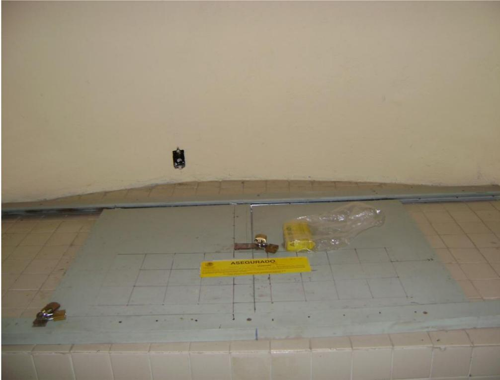
**Figura 2. Compartimiento con blindaje donde está asegurada la fuente de neutrones de Pu-Be**
