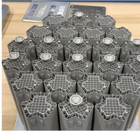
**Figura 7. Prototipos de componentes nucleares impresos en metal [9].**
