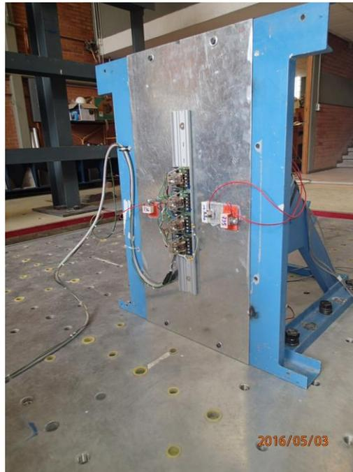
**Figura 2. Instalación de los relevadores marca Square D tipo KPD13, para las pruebas OBE y SSE (dirección Lado-Lado/Vertical).**
