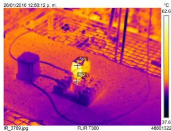
**Figura 1. Termografía del relevador marca Square D tipo KPD13.**
