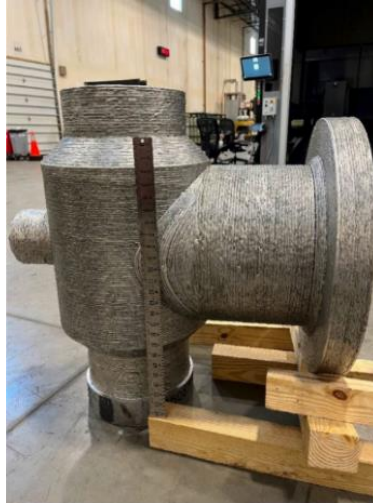
Figura 9. Válvula construida con arco metálico de gas DED [12].
