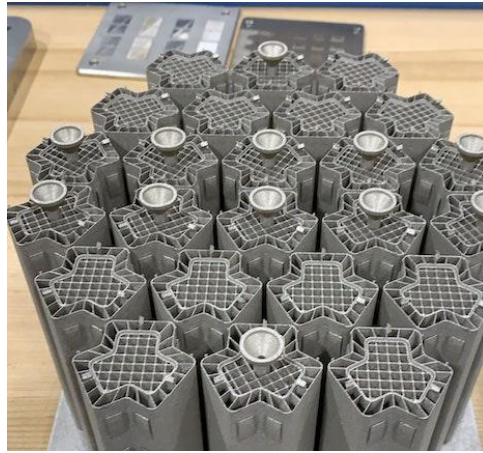
Figura 7. Prototipos de componentes nucleares impresos en metal [9].
