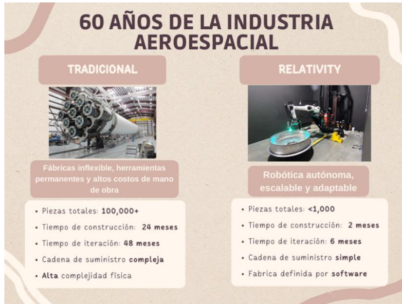
Figura 4. Comparación en el proceso de fabricación 3D de Relativity Space [5].
