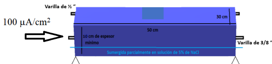
Figura 4. Losa de concreto reforzado fabricada.
