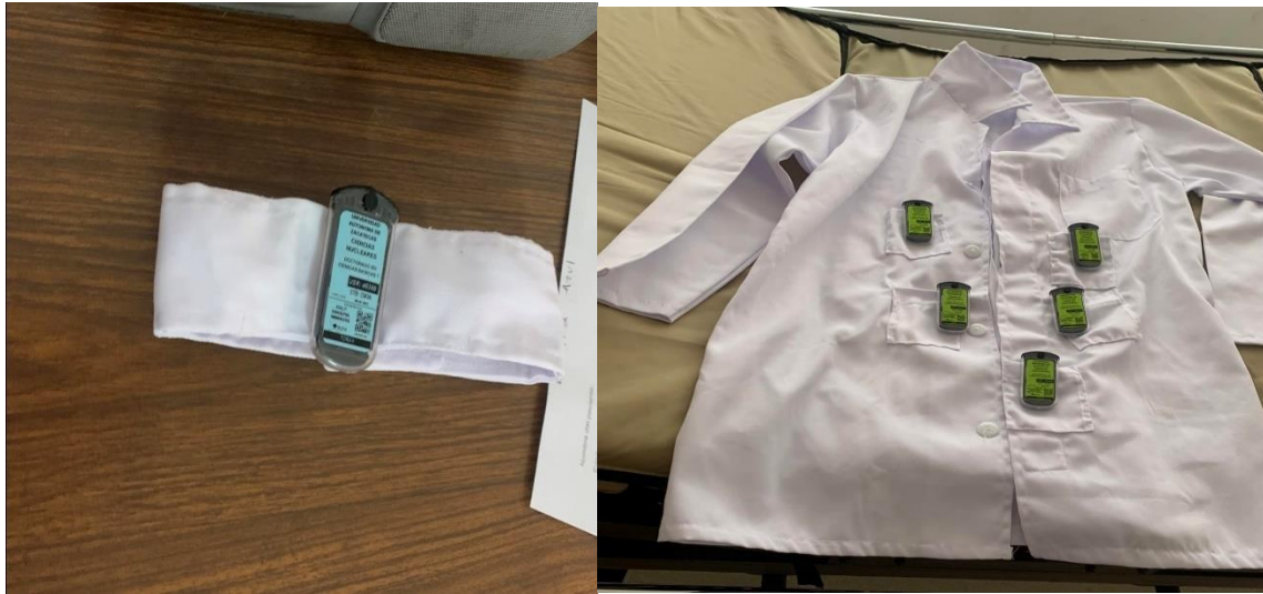
Figura 7. A la izquierda se muestra el collarín que se utilizó en el tratamiento con su respectivo dosímetro y a la derecha la bata con los dosímetros para de medición de los otros órganos.
