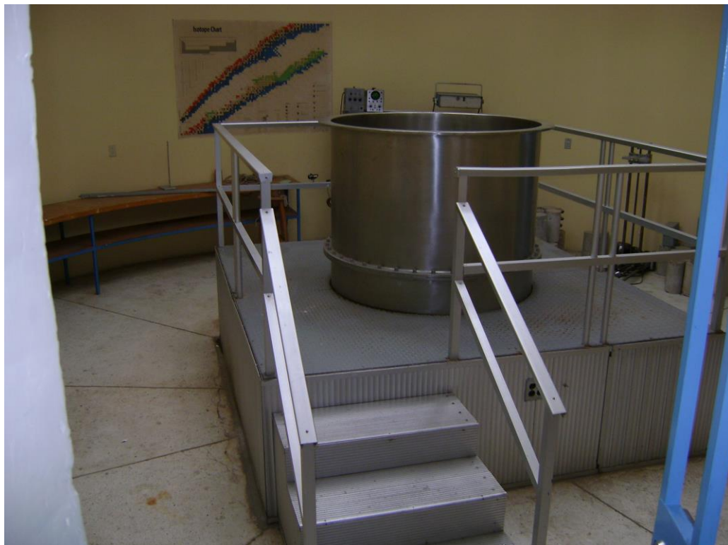
Figura 7. Vasija de acero inoxidable del reactor nuclear subcrítico de la UAZ.
