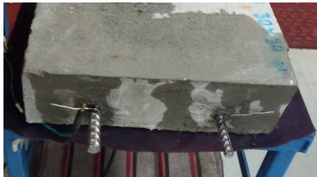
Figura 7. Losa de concreto reforzado recién fabricada.
