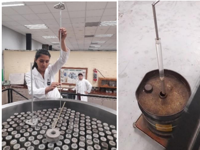
Figura 2. a) A la izquierda la introducción del arreglo en el subcrítico. b) A la derecha la fuente de neutrones a introducirse en el subcrítico
