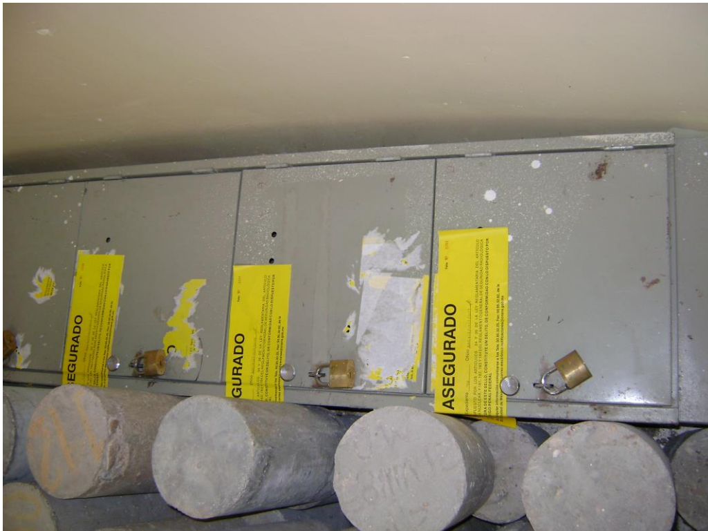
Figura 1. Gavetas donde están asegurados los elementos combustibles de uranio natural.
