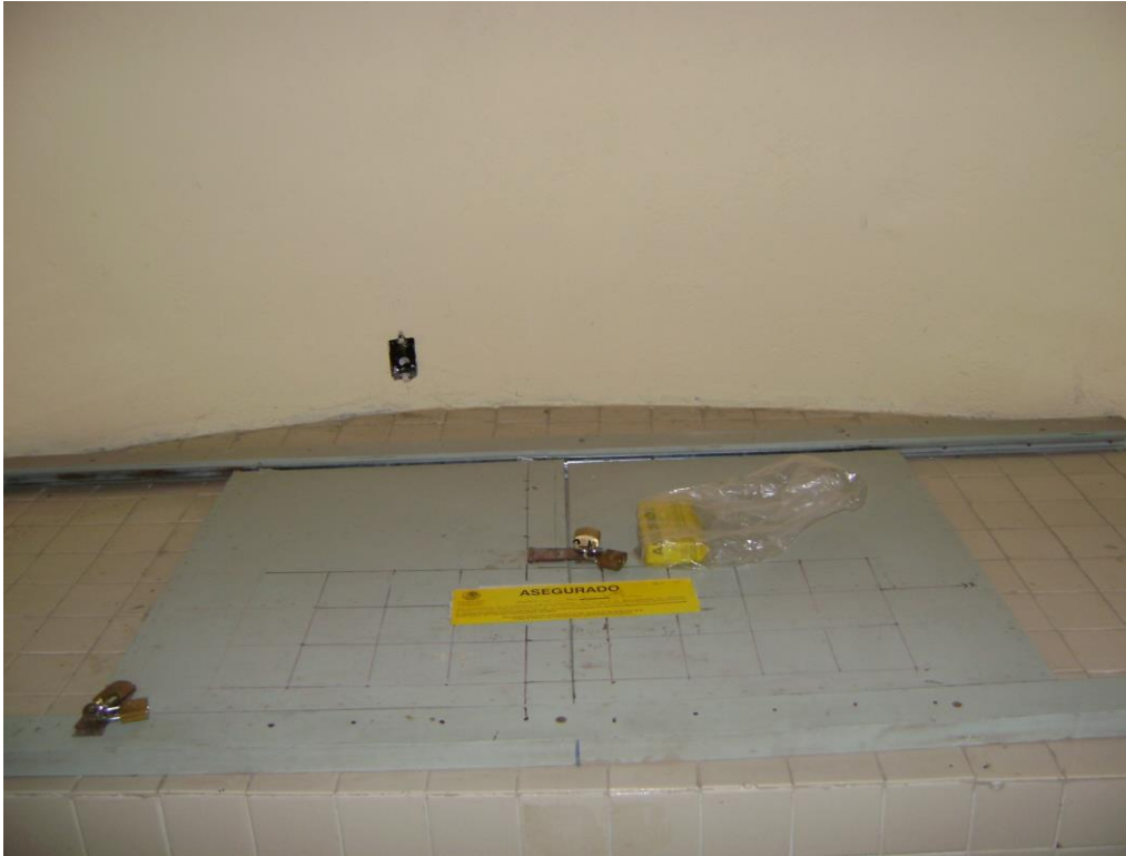
Figura 2. Compartimiento con blindaje donde está asegurada la fuente de neutrones de Pu-Be
