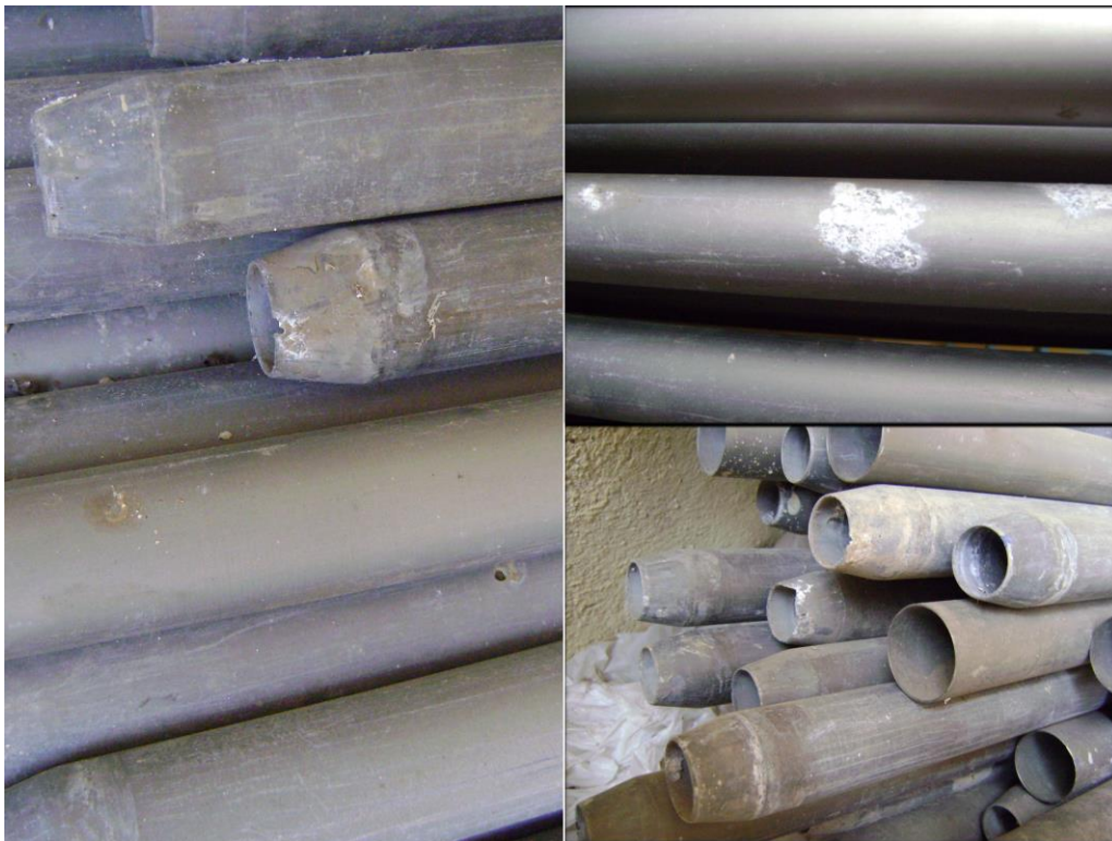
Figura 5. Estado de los tubos de aluminio que alojan a los cilindros huecos de uranio.
