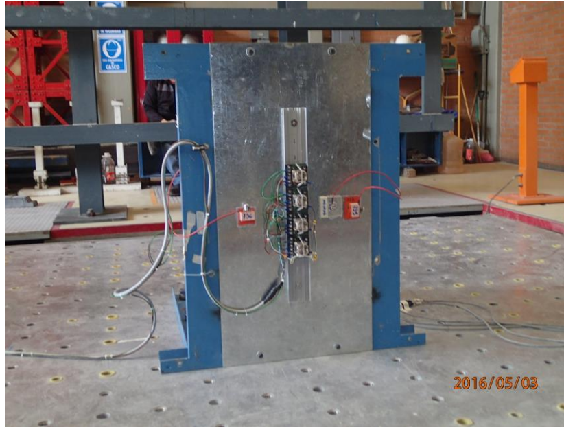
Figura 3. Instalación de los relevadores marca Square D tipo KPD13, para las pruebas OBE y SSE (dirección Frente-Atrás/Vertical).
